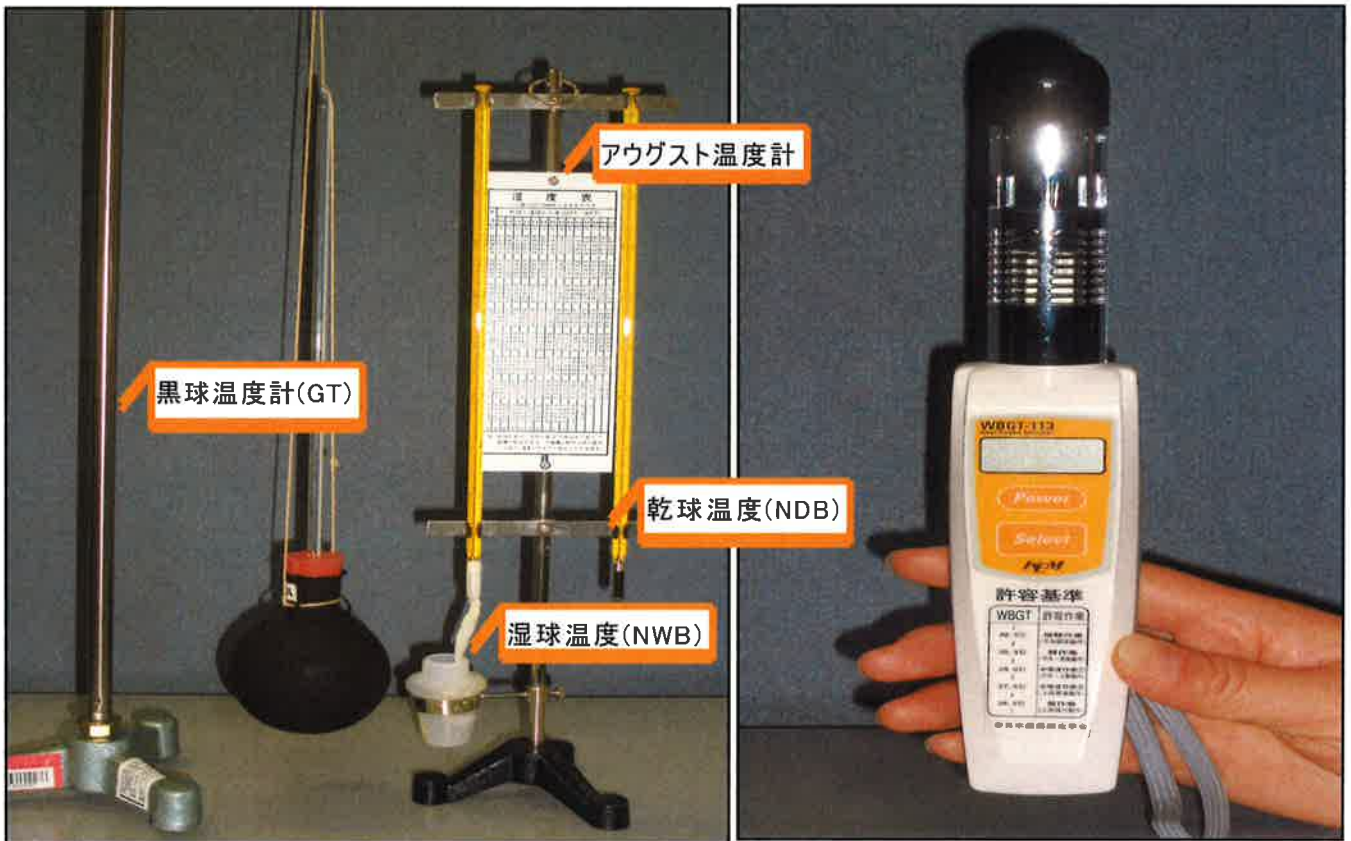
黒球温度計とアウグスト温度計を組み合わせたWBGT測定機器
